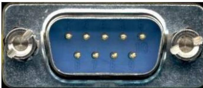
Nel caso non si abbiano a disposizione porte RS-232 sul PC è necessario dotarsi di un dispositivo convertitore RS-232 / USB e relativo driver.
